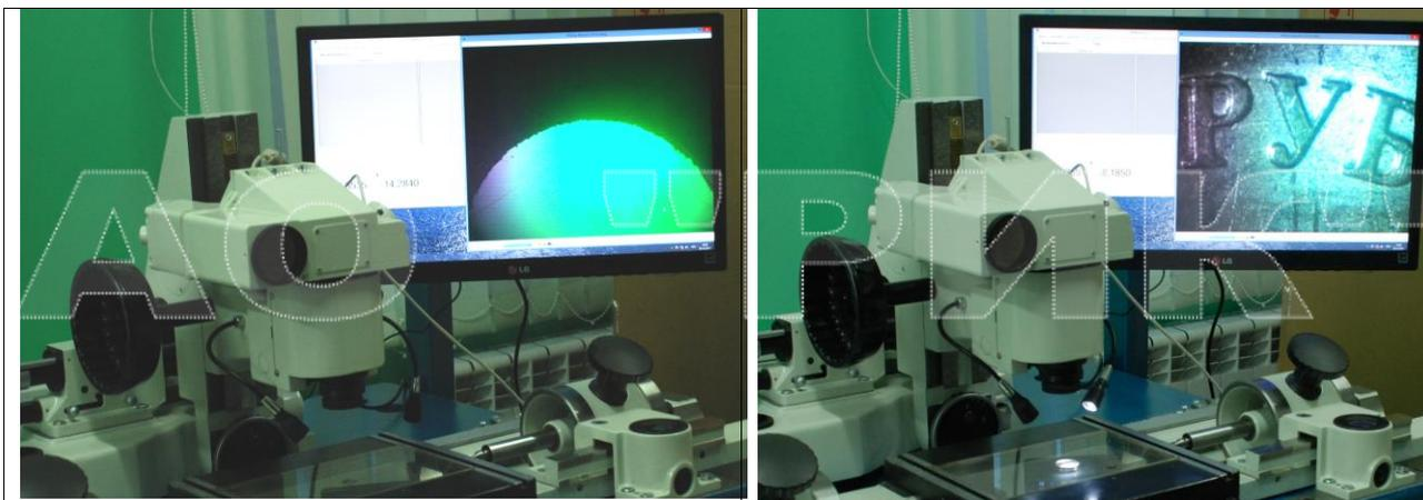
Изображение с видеопроекционной насадки может быть выведено на экран монитора как в полноэкранный режим для более точного исследования измеряемого объекта или совмещения центра угломерной сетки с необходимой точкой на объекте, так и одновременно с софтом ПО.
